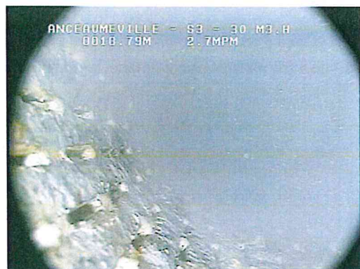
Colonne d'eau « centrale » chargée en turbidité avec venues d'eau claire depuis l'ensemble de la crépine de plus en plus faibles, eau turbide à partir de -20,20 m/R
