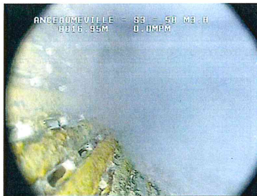
Colonne d'eau « centrale » chargée en turbidité avec venues d'eau claire depuis l'ensemble de la crépine
