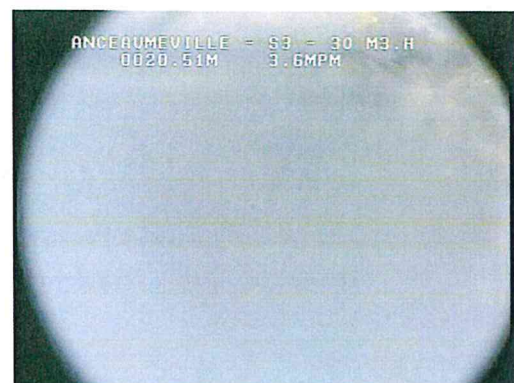
Colonne d'eau « centrale » chargée en turbidité avec venues d'eau claire depuis l'ensemble de la crépine de plus en plus faibles, eau turbide à partir de -20,20 m/R
