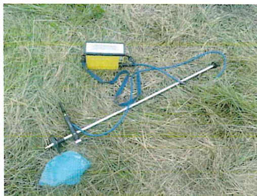
Clichés : Vélocimètre électromagnétique utilisé dans le cadre de la présente mission (crédit photo explor-e)
